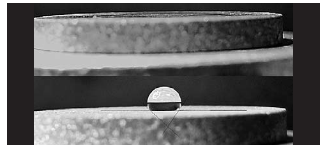
Abb. 16: Vergleich der Ausbreitung eines Wassertropfens auf superhydrophiler (oben) und hydrophober Titanoberfläche (unten).
