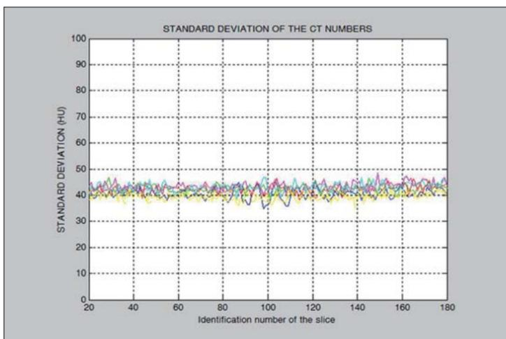
Abb. 6: Messung der Standardabweichung von Wasser (HU 0).
