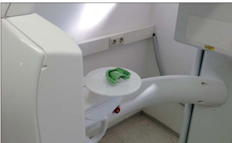
Abb. 17, 18: CBCT-Scan von Kunststoffabformlöffeln mit Silikon.
