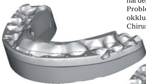
Abb. 5: Computerunterstütztes Designen (CAD) der chirurgischen Splints. Oben der Interimsplint, unten der finale Splint.
