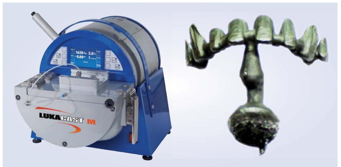
Hierbei wird die Form zuerst mittels Unterdruck (Vakuum) evakuiert. Mit dem Auslösen des Gießvorganges wird das Metall schonend mit 2 bar Überdruck in jeden Winkel der Form gepresst. Die Ergebnisse sind homogen und qualitativ hervorragend. Die Firma Lukadent hat sich seit Jahren auf den Vakuum-Druckguss spezialisiert. Mit der Lukacast S wurde 2009 ein Gerät auf den Markt gebracht, das viele Vorteile gegenüber den bis dahin etablierten Geräten auf-
