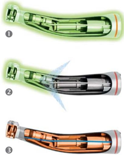
Der Gesamtprozess im Überblick: 1: Innenreinigung der Spraykanäle und Getriebeteile, Außenreinigung des Instruments. – 2: Durchblasen der Spraykanäle mittels Druckluft. – 3: Schmierung der Getriebeteile mit W&H Service Oil F1.
