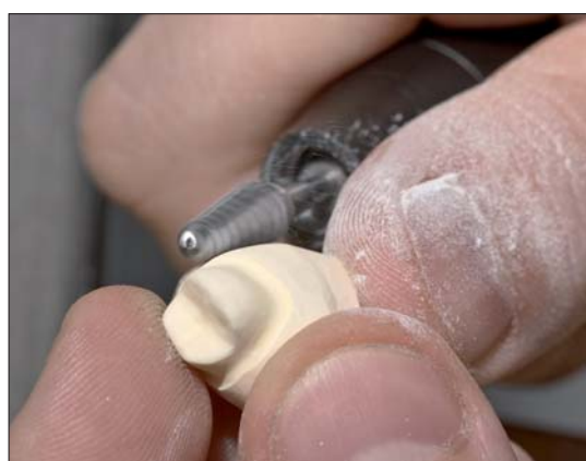
Abb. 21: Die einzelnen Stümpfe nimmt man heraus und schleift sie am besten mit Fräsern mit E-Verzahnung, wie dem H79E von KOMET/GEBR. BRASSELER, grob zu.
