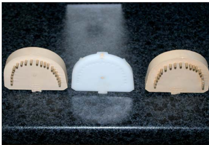
Abb. 6: Probanden: links ZERO stone, rechts ein normal expandierender Superhartgips.
