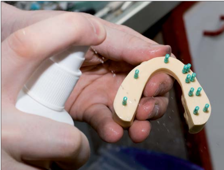
Abb. 15: ... und der Zahnkranz gegen Gips isoliert.
