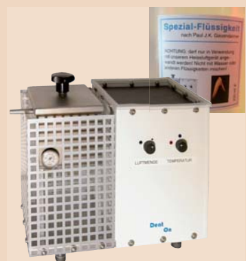
Abb. 29: Anmischmedium und Heissluftgerät, beides entwickelt vom Autor.
