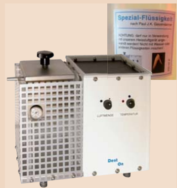
Abb. 29: Anmischmedium und Heissluftgerät, beides entwickelt vom Autor.
