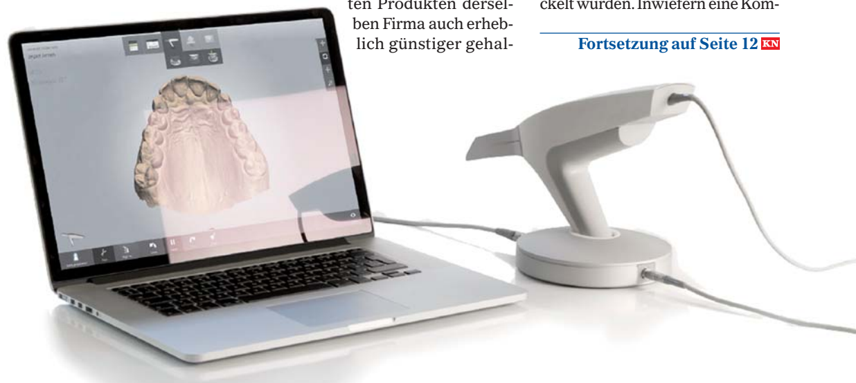
Abb. 4a: Intraoraler Scanner. Exemplarisches Beispiel für einen intraoralen Scanner (3Shape TRIOS® Pod).
