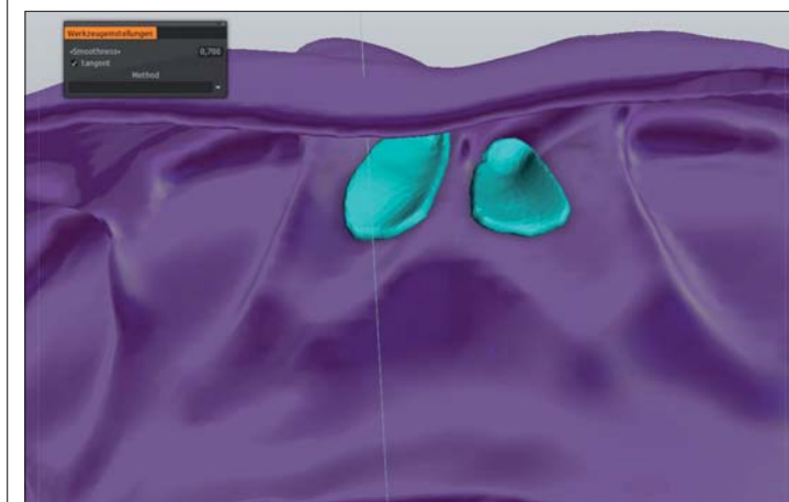
Abb. 38: CAD PlastyCAD UK-Schiene Extrudierung 0,2mm 31, 41 geglättet.
