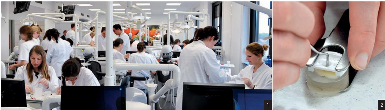
Abb. 1: Die Studierenden bei Erstellung der Proben. – Abb. 2: Komposit-Füllungsmaterial wird mithilfe einer Kunststoffform an einem Rinderzahn befestigt.
