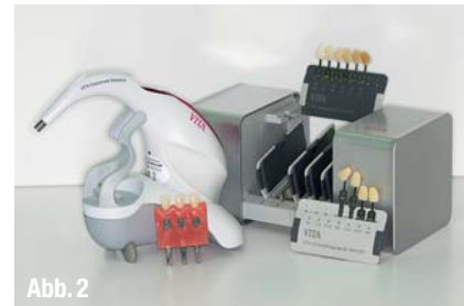
▲ Abb. 1: Das Farbsystem von Munsell teilt Farben in drei Dimensionen: Value (Helligkeit), Chroma (Sättigung), Hue (Ton). Bildquelle: Wikimedia Commons, Jacob Rus. ▲ Abb. 2: Unser Equipment für die Farbbestimmung: Farbskala (VITA Linearguide 3D-MASTER, VITA Zahnfabrik), elektronisches Farbmessgerät (VITA Easyshade Advance, VITA Zahnfabrik), Farbring mit Zahnfleischmaske. Grundlage ist das VITA SYSTEM 3D-MASTER (nach Klassifikation von Munsell). 1. Bestimmung der Helligkeit (Value), 2. Bestimmung der Farbintensität (Chroma) und des Farbtons (Hue).
