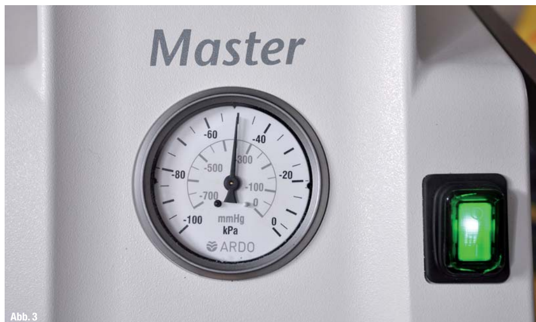
Abb. 3: Zu hoher Sog schädigt die Zellen. Die Absaugung sollte auf nicht mehr als 0,5 bar eingestellt werden.
