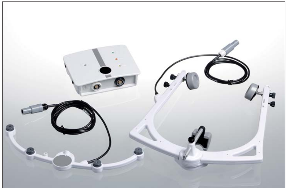
Abb. 2: SICAT JMT+ zur Aufnahme von elektronischen Bewegungsmessungen.
