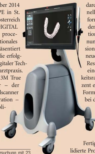
dards in der konventionellen Präzisionsabformung gesetzt. Mit dem 3M True Definition Scanner erreicht nun die digitale Präzisionsabformung eine neue Ebene: Es werden Restaurationen mit einer Passgenauigkeitsrate von 99,7 Prozent erzielt.<sup>1</sup> Dank STL-Formatist der Anwender bei der Umsetzung der vielfältigen Nutzungsmöglichkeiten flexibel in der Wahl von Workflows und
