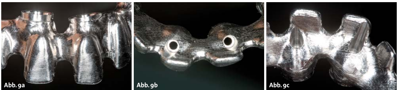
Abb. 9a–c: Das gefräste CoCr-Gerüst von frontal, okklusal und lingual.
