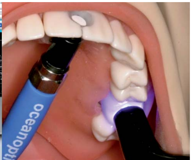
Abb. 4a, b: Das 2009 entwickelte Managing Accurate Resin Curing (MARC) System besteht aus einem Phantomkopf, der über kalibrierte Sensoren in zwei Kavitäten verfügt. Das Testgerät misst Lichtintensität und Wellenlängen und kann, im Gegensatz zu meist geräteinternen Radiometern, Daten über die Lichtleistung liefern, die tatsächlich in der Kavität ankommt.
