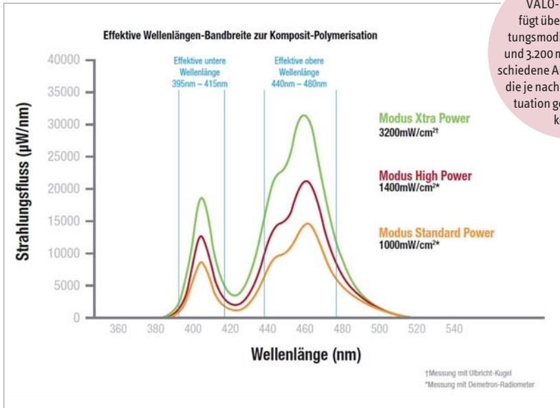
**Abb. 3:** Die VALO-Leuchte verfügt über drei Aushärtungsmodi mit 1.000, 1.400 und 3.200 mW/cm<sup>2</sup> und verschiedene Aushärtungszeiten, die je nach Behandlungssituation gewählt werden können.
