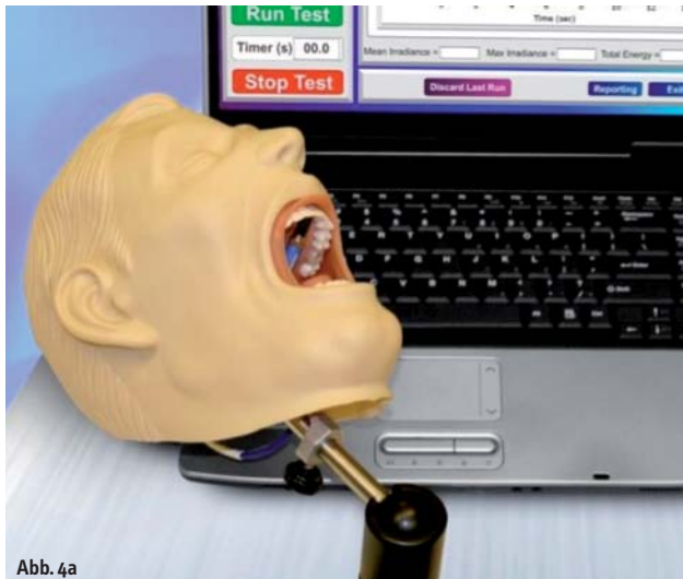
Abb. 4a, b: Das 2009 entwickelte Managing Accurate Resin Curing (MARC) System besteht aus einem Phantomkopf, der über kalibrierte Sensoren in zwei Kavitäten verfügt. Das Testgerät misst Lichtintensität und Wellenlängen und kann, im Gegensatz zu meist geräteinternen Radiometern, Daten über die Lichtleistung liefern, die tatsächlich in der Kavität ankommt.
