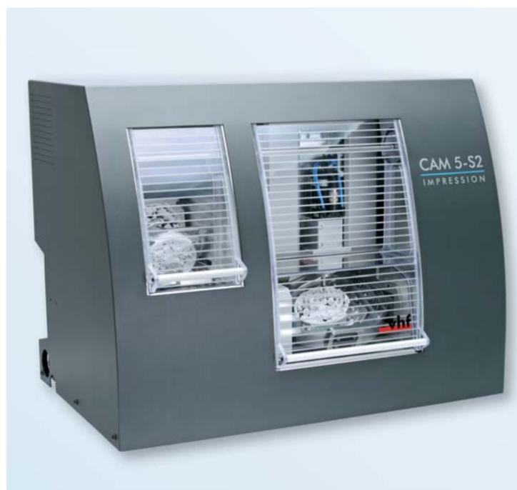
ist baugleich mit dem 5-Achs-Simultan Bearbeitungssystem CAM 5-S1 Impression, verfügt jedoch zusätzlich über den integrierten 8-fach-Blankwechsler für den automatisierten Betrieb. So wird die Fertigungskapazität ganz einfach über Nacht erhöht. Aufgrund der Verarbeitung von Universalblanks mit 98,5 mm Durchmesser wird die Nutzung handelsüblicher Materialien der
