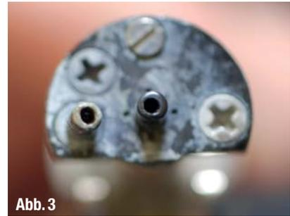
▲ Abb. 3: Biofilm und Kalkablagerungen an der Luft-Wasser-Spritze.
