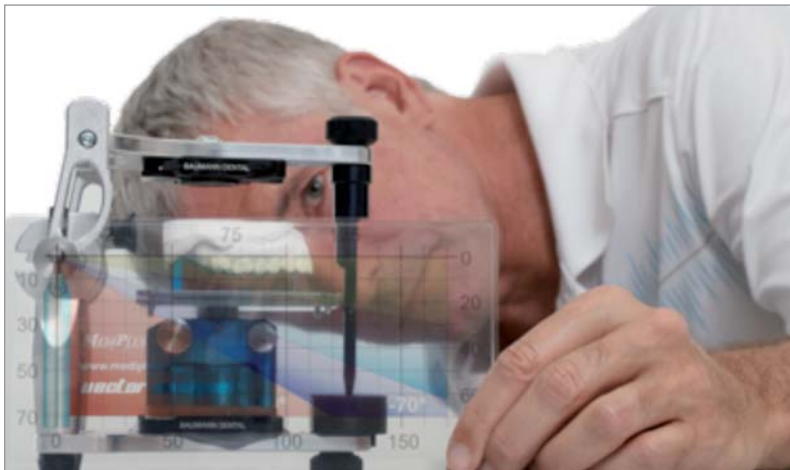
Abb. 9: Mit dem HIP-Mount kann das obere Modell vertikal und sagittal gezielt im Artikulator angeordnet werden. Gezeigt ist hier ein Prototyp eines neuen Artikulators, dessen Dimensionierung hier wesentlich freizügiger ist.
