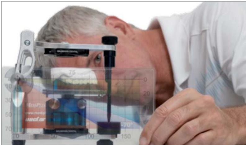
Abb. 9: Mit dem HIP-Mount kann das obere Modell vertikal und sagittal gezielt im Artikulator angeordnet werden. Gezeigt ist hier ein Prototyp eines neuen Artikulators, dessen Dimensionierung hier wesentlich freizügiger ist.
