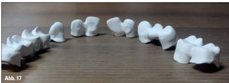
Abb. 17: Die 14 Einheiten nach dem Verschleifen der Konnektoren, vor dem Tauchen und Sintern.
