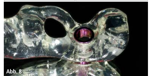
Abb. 7a: SLA-Druckverfahren. – Abb. 7b: 3-D-Drucker DWS 028D. – Abb. 8: DWS 028D-3-D-Druck einer Bohrschablone.
