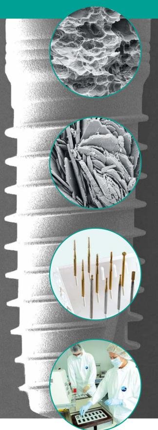
Gestrahlte/geätzte Oberflächen (DUOTex®, CELLTex®)
