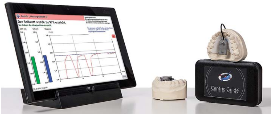
Abb. 1: System Centric Guide, inklusive Messschablonen.
