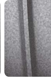
Bionische Mikrorillen zur Spannungsreduzierung
