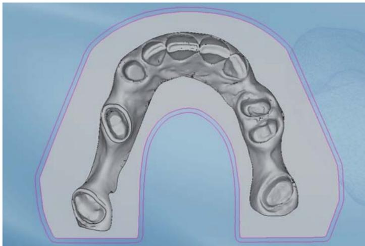
Das ProfiCad System von ERNST HINRICHS ist ein Verfahren zur wirtschaftlichen Herstellung von Arbeitsmodellen nach intraoralem Scannen. Dabei werden bereits etablierte Frässysteme in den Laboren mit dem Traditionswerkstoff Gips kombiniert und
