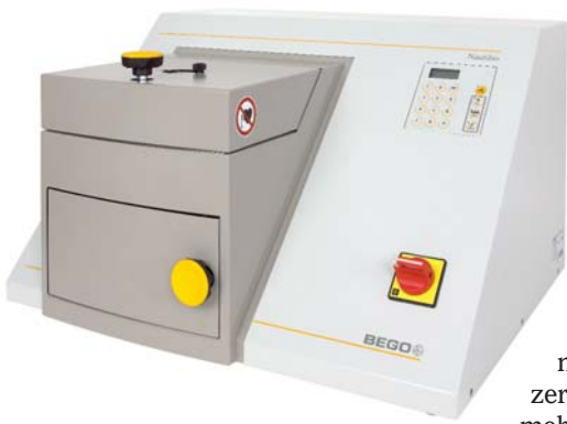
Ein Wärmetauscher sorgt dafür, dass die Nautilus® T nach einer Überhitzung wieder schnell einsatzbereit ist.
