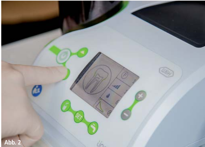
Abb. 2: Vier voreingestellte und ein frei wählbares Programm ermöglichen ein effizientes Arbeiten. – Abb. 3: Die gute Ausleuchtung mittels 5-fach LED-Ring erlaubt eine gezielte und effiziente Konkremententfernung.
