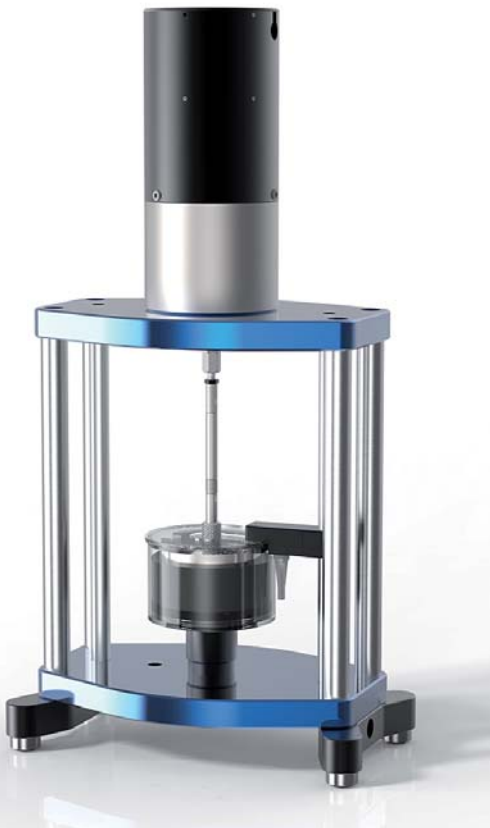
Abb. 4: Einzelprüfanlage mit beheiztem Prüfbecken.
