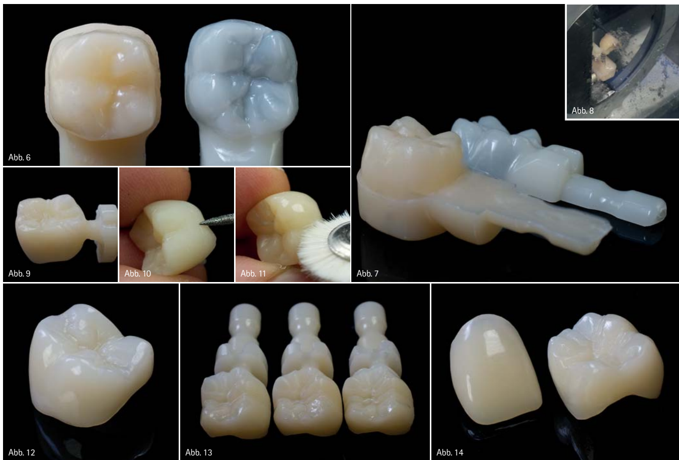
Abb. 6: Dreidimensionaler Aufbau der Dentin-Schneide-Grenze des Rohlings. – Abb. 7: Der natürliche Farbverlauf ist im Rohling integriert. – Abb. 8: Die Fertigung der Kunststoffkrone in der CAM-Fräsmaschine. – Abb. 9: Krone direkt nach der Fräsung. – Abb. 10 und 11: Zur manuellen Fertigstellung verbleiben nur noch die Oberflächencharakterisierung und die Politur. – Abb. 12: Gefertigte Restauration aus dem pritidenta PMMA-Kronenrohling. – Abb. 13: Eins-zu-eins-Kopien als „Reparaturset“. – Abb. 14: Kronen aus hochvernetztem PMMA.
