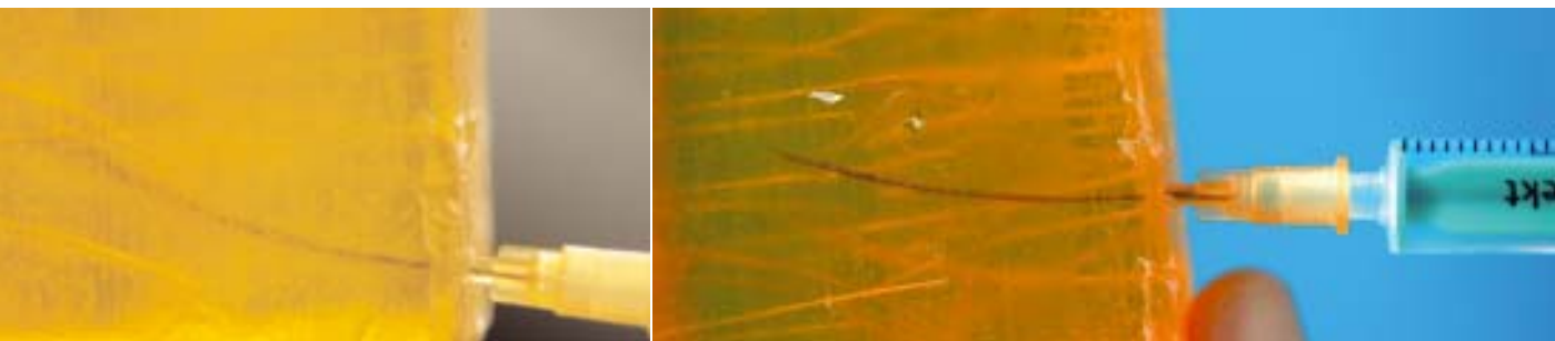
Abb. 1a und b: Deflektion einer Kanüle im Gewebe, hier an einem Dummy demonstriert.
