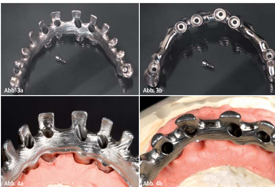
Abb. 3a und b: Gemäß der Planung gefrästes Titan-Brückengerüst mit angulierten Schraubenzugängen für XiVE-MP-Aufbauten. – Abb. 4: Detailaufnahmen der a) präzise und b) winkelgradgenau ausgefrästen Schraubenzugänge.
