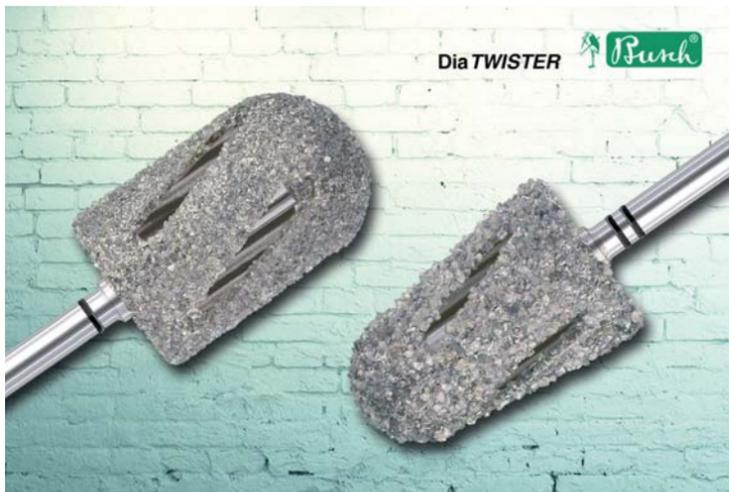
men. Die Diamantschleifer der DiaTWISTER-Serie wirken dem entgegen. Das Besondere der Arbeitsteile sind deren speziell angeordnete Öffnungsschlitze, die während des Schleifvorganges für eine optimale Luftzirkulation sorgen und somit einem eventuellen Überhitzen des Werkstoffes vorbeugen. Die verminderte Wärmeentwicklung wirkt gleichzeitig einem Zuschmieren des Instrumentes entgegen. Die einteilige Konstruktion der Instrumente bürgt für eine exakte Rundlaufgenauigkeit und eine
