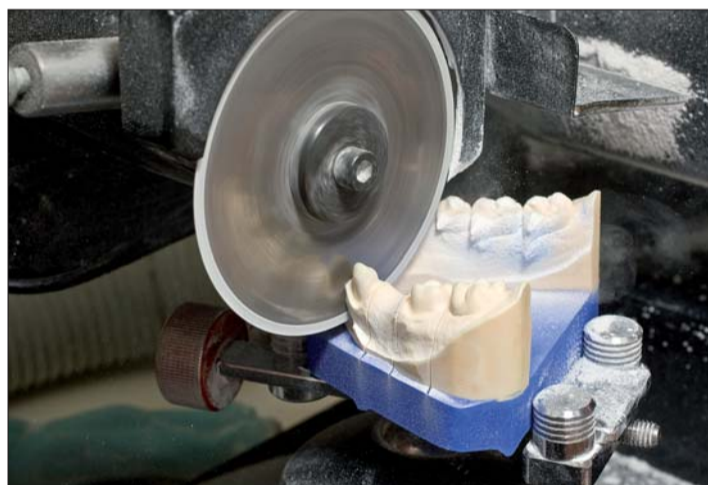
Abb. 2: Mit einer Säge oder einer großen Diamantscheibe werden die einzelnen Stümpfe gesägt.
