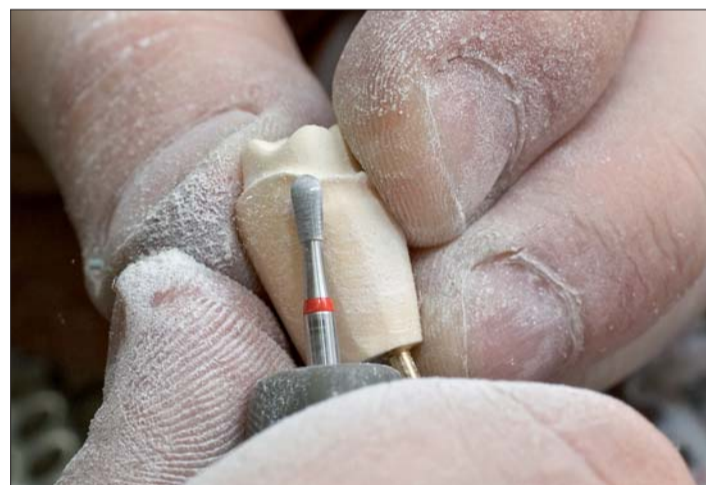
Abb. 4: Zuerst mit einem groben H79E-Fräser und dann mit einem H77EF-Fräser von KOMET/GEBR. BRASSELER wird die Präparationsgrenze der Stümpfe vorsichtig freigelegt und Platz für die Zahnfleischmaske geschaffen.
