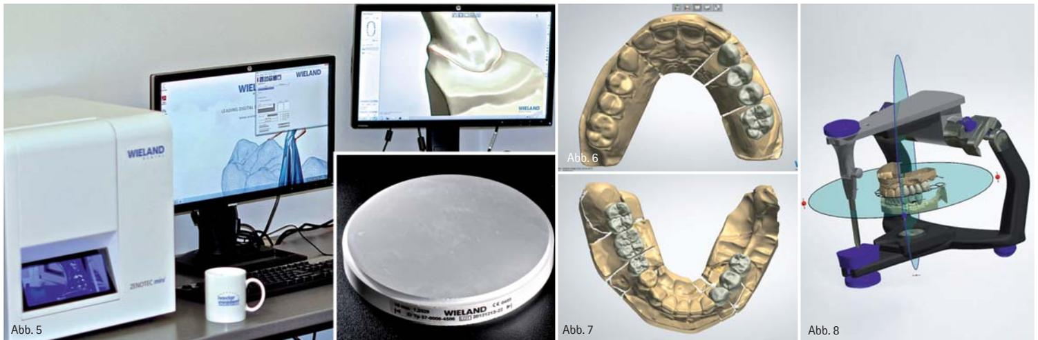
Abb. 5: Wieland-Arbeitsstation mit Zenotec Mini und ZrO<sub>2</sub>-Disc. – Abb. 6: Konstruktion der Brücke 23 bis 26 in der 3Shape-Software. – Abb. 7: Konstruktion der Brücken 33 bis 35 mit Anhänger 36 und 45 bis 47. – Abb. 8: Virtueller Artikulator zur Erarbeitung der funktionellen Gegebenheiten.
