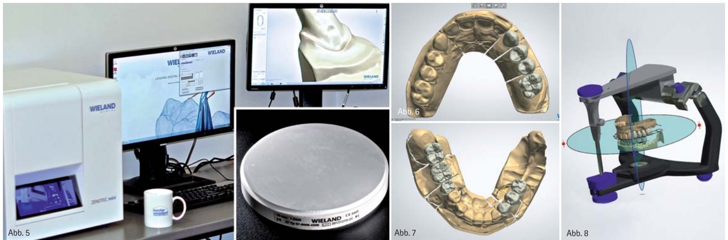
Abb. 5: Wieland-Arbeitsstation mit Zenotec Mini und ZrO 2 -Disc. – Abb. 6: Konstruktion der Brücke 23 bis 26 in der 3Shape-Software. – Abb. 7: Konstruktion der Brücken 33 bis 35 mit Anhänger 36 und 45 bis 47. – Abb. 8: Virtueller Artikulator zur Erarbeitung der funktionellen Gegebenheiten.
