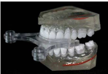
Abb. 1 und 2: DVT-Phantom („Kieferhöhlenboden“ und „Nervus alveolaris mandibulae“ sind mit röntgendichten Drahtstrukturen simuliert). – Abb. 3: DVT-Phantom in einem Volumentomografen (KODAK 9000 3-D, kleines Volumen) auf der Original-Patienten-Einbisshilfe fixiert.
