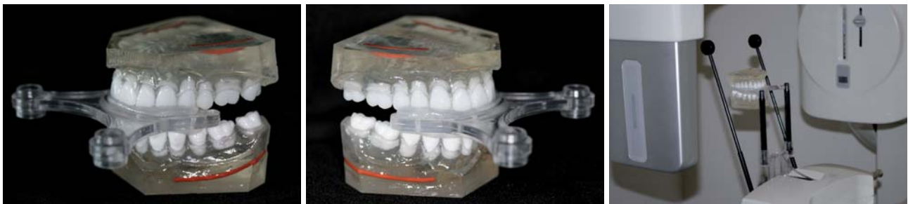
Abb. 1 und 2: DVT-Phantom („Kieferhöhlenboden“ und „Nervus alveolaris mandibulae“ sind mit röntgendichten Drahtstrukturen simuliert). – Abb. 3: DVT-Phantom in einem Volumentomografen (KODAK 9000 3-D, kleines Volumen) auf der Original-Patienten-Einbisshilfe fixiert.
