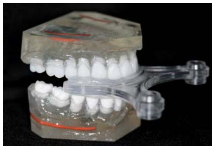
Abb. 1 und 2: DVT-Phantom („Kieferhöhlenboden“ und „Nervus alveolaris mandibulae“ sind mit röntgendichten Drahtstrukturen simuliert). – Abb. 3: DVT-Phantom in einem Volumentomografen (KODAK 9000 3-D, kleines Volumen) auf der Original-Patienten-Einbisshilfe fixiert.
