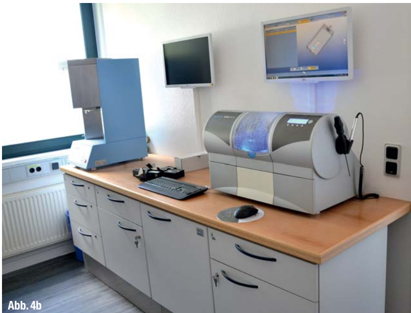
▲ Abb. 4a und 4b: Der neue Fräs- und Schleifraum im 1. OG mit der Dentalfräse Cercon® brain expert von DeguDent (4a) und dem Sinterofen heat DUO von DeguDent (4b) sowie der Schleifeinheit brain MC XL von DeguDent (4b).
