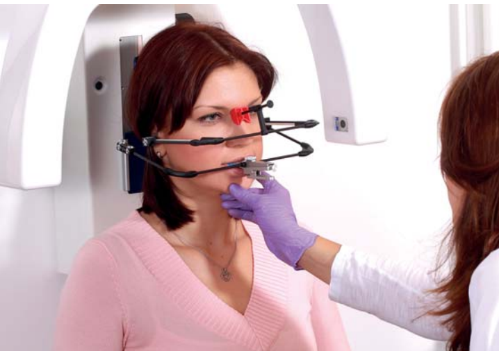
Abb. 2: Mit dem Freecorder®BlueFox ist die berührungslose digitale Aufzeichnung der Kiefergelenkbewegungen möglich.
