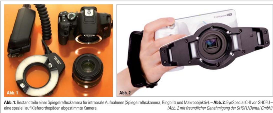
Abb. 1: Bestandteile einer Spiegelreflexkamera für intraorale Aufnahmen (Spiegelreflexkamera, Ringblitz und Makroobjektiv). – Abb. 2: EyeSpecial C-II von SHOFU – eine speziell auf Kieferorthopäden abgestimmte Kamera.
