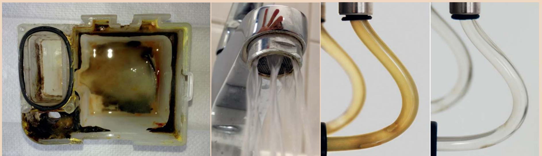
Einer der höchsten Kostenposten wird bauartbedingt durch Dentaleinheiten verursacht. Materialwahl von Schläuchen und Verbindern sowie das Design der Bauteile verhindern eine sehr gute Haltbarkeit und fördern speziell durch Biofilm induzierte Defekte.
