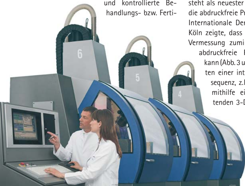
Abb. 5: Zur Bearbeitung von ZrO_2 -Keramik für Kronen- und Brückengerüste verfügen Fräszentren über eine ausgeklügelte Qualitätssicherung (Foto: etkon-Straumann).
