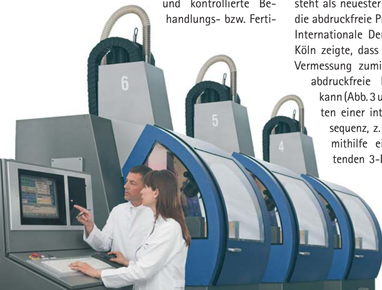
Abb. 5: Zur Bearbeitung von ZrO_2 -Keramik für Kronen- und Brückengerüste verfügen Fräszentren über eine ausgeklügelte Qualitätssicherung (Foto: etkon-Straumann).
