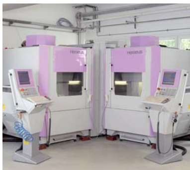
Abb. 6: Fräszentren sind auf standardisierte Fertigungsverfahren unter besonders wirtschaftlichen Gesichtspunkten eingestellt (Foto: Heraeus Kulzer).
