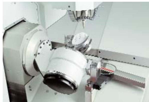
Innenraum der 5-achsigen RXD5 für 5-Achssimultanbearbeitung, Direktspannung der Rohlinge mit Spezialgreifer.
