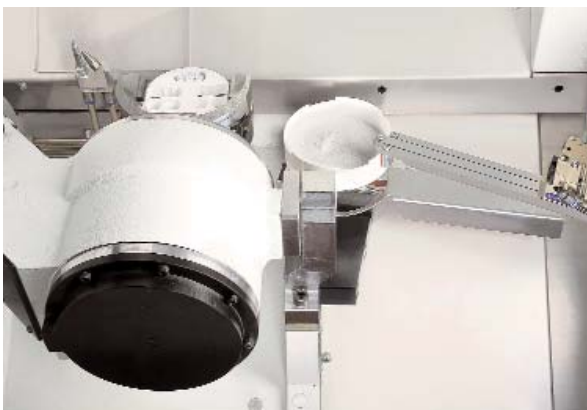
Abtransport einer einzelnen Dentalarbeit, die aus dem Rohling herausgefräst wurde.
