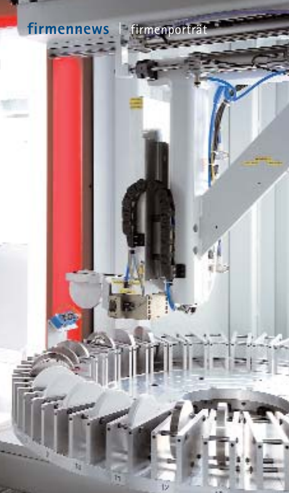
Handlingsgerät für Einmaschinenautomation, gemischter Betrieb unterschiedlicher Materialien möglich.
