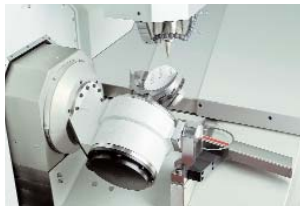
Innenraum der 5-achsigen RXD5 für 5-Achssimultanbearbeitung, Direktspannung der Rohlinge mit Spezialgreifer.
