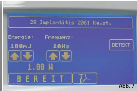
Abb. 6: Speziell für periimplantäre Therapieschritte entwickelte Konfiguration dieses Saphirmeisels mit Abschrägung am Arbeitsende soll das Laserlicht auch in die Unterschnittsbereiche der Gewindegänge leiten. – Abb. 7: Display (Touchscreen) des KaVo KEY Laser 3+.
