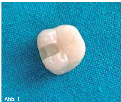
Abb. 1: Zur Prüfung der Kompressionsbruchfestigkeit griffen die Wissenschaftler auf Modellzähne aus Zirkonkeramik zurück ... – Abb. 2: ... diese wurden mit Füllungen vier verschiedener Glasionomerzemente versorgt.
