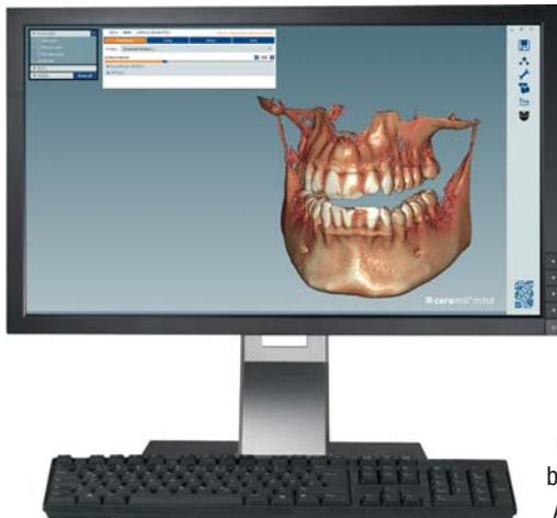
Das Ceramill Mind Upgrade-Modul „Ceramill Dicom Viewer“ ist eine Visualisierungs- und Kommunikationssoftware. Sie erlaubt, Daten aus CT- oder DVT-Geräten (DICOM-Format) einzulesen, darzustellen und mit STL-Daten zusammenzuführen, um tiefer liegende oder oberflächige anatomische Strukturen
