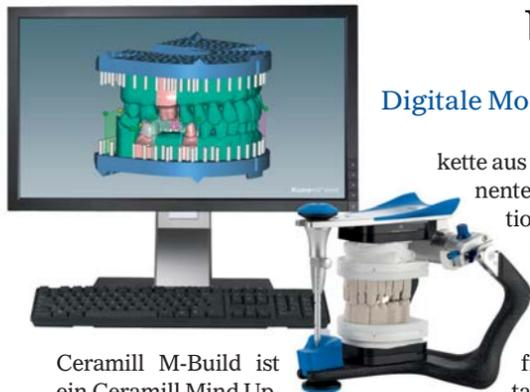
Ceramill M-Build ist ein Ceramill Mind Upgrade-Modul für die Inhouse-Fertigung von Präzisionsmodellen auf Basis intraoraler Scandaten. Die Software erlaubt eine komfortable und effiziente Herstellung von passgenauen Sägeschnittmodellen mittels CAD/CAM und fügt sich nahtlos in die bestehende Prozess-
