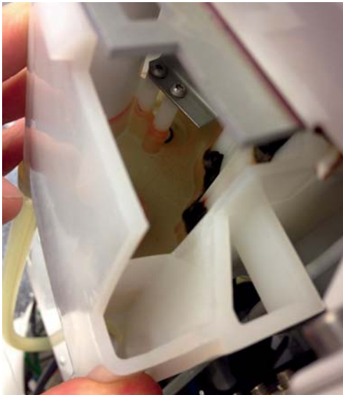
Abb. 1: Freie Fallstrecke gemäß DIN EN 1717 in Dentaleinheit.
