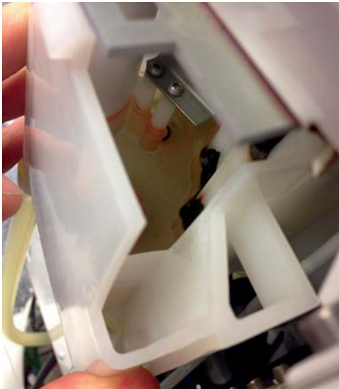
Abb. 1: Freie Fallstrecke gemäß DIN EN 1717 in Dentaleinheit.
