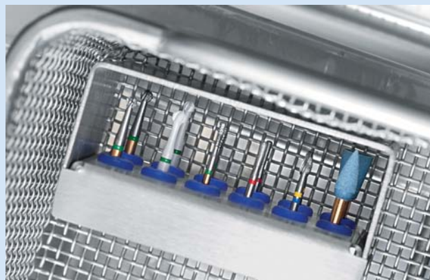
Abb. 2: Werden Instrumente in einem Reinigungs- und Desinfektionsgerät (RDG) aufbereitet, ist darauf zu achten, dass die Edelstahlträger gelegt werden, damit kein Spülschatten entsteht.
